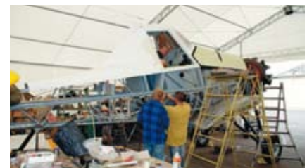
Die Maschine wurde bei PZL komplett neu aufgebaut.
