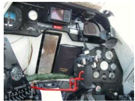
Das Cockpit hat im Zentrum ein Sichtfenster zum Hopper um dessen Füllstand anzuzeigen.
